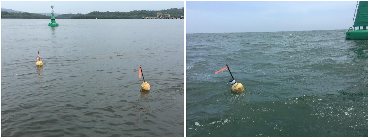
Derivadores de corrientes con GPS empleado en el estudio hidrodinámico de Bahía Las Minas
