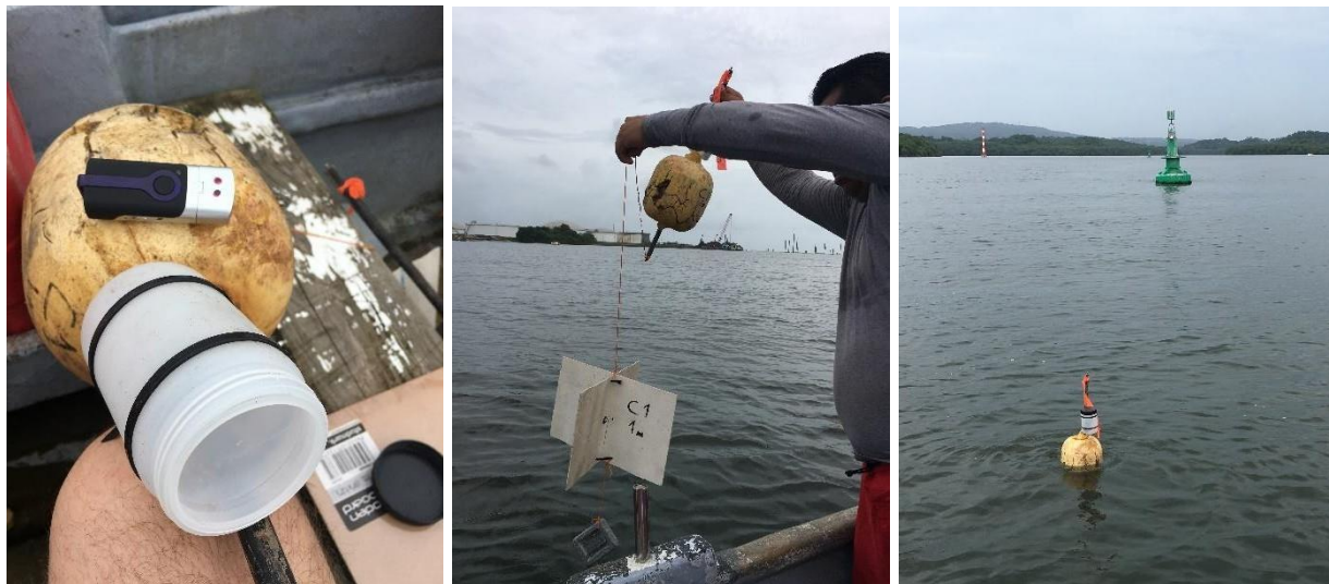
Derivadores de corrientes con GPS empleado en el estudio hidrodinámico de Bahía Las Minas
