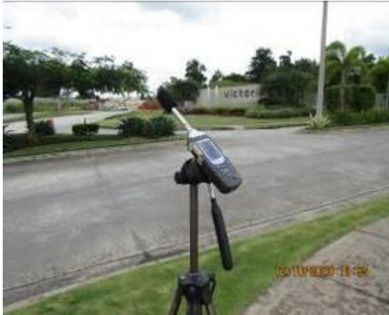
Imágenes 4.5 y 4.6. Equipo de medición de ruido ambiental colocado en el P3: Diagonal a PH Victoria
