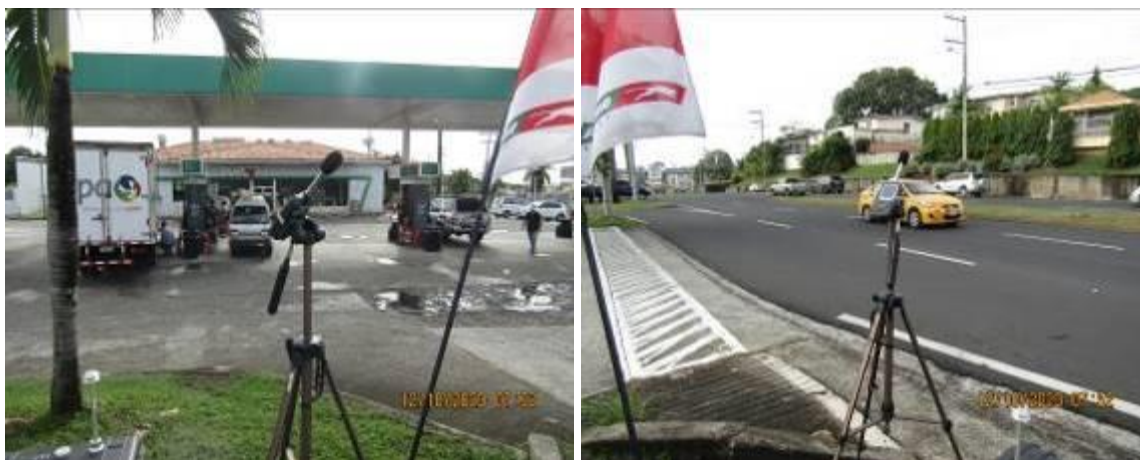
Imágenes 4.1 y 4.2. Equipo de medición de ruido ambiental colocado en el P1: Estación Puma Brisas del Golf
