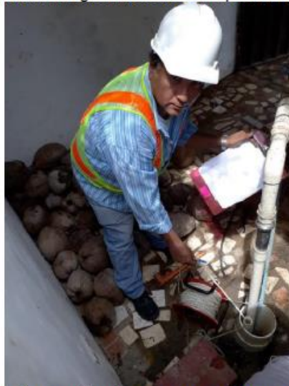
Fig.11- Registro del descenso durante el bombeo a 30 gpm en el pozo PP1(nótese el tubo piezométrico, de 1 pulgada de diámetro dentro del cual se introduce la sonda eléctrica para la medición de los niveles dinámicos vs tiempo).
