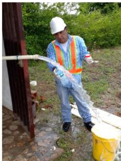
Fig.27, 28- Toma de muestra para análisis físico-químico completo y bacteriológico de laboratorio en el pozo PP1 (proceso de enjuague de recipientes y toma) – proyecto Urbanización Santamaría
