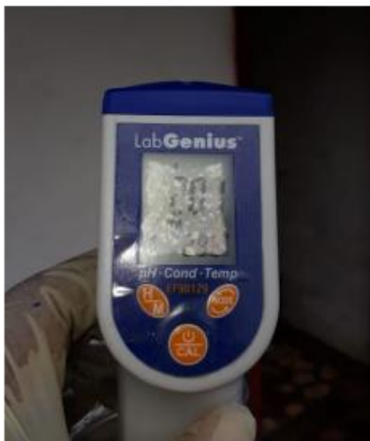
Fig.25 y 26- Medición en campo de sólidos totales disueltos del agua (mg/l) y conductividad eléctrica (μSiemens/cm)
