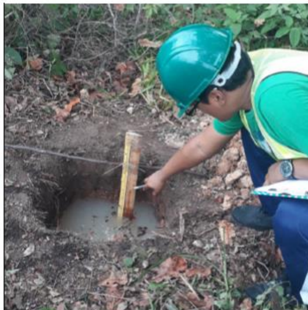
Figura 23- Realización de prueba de infiltración de suelos con el método de Porchet- Proyecto Urbanización Santamaría
