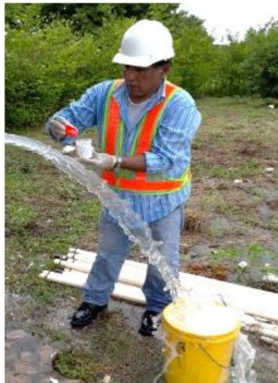
Fig.27, 28- Toma de muestra para análisis físico-químico completo y bacteriológico de laboratorio en el pozo PP1 (proceso de enjuague de recipientes y toma) – proyecto Urbanización Santamaría
