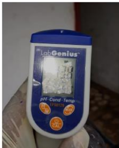
Fig.25 y 26- Medición en campo de sólidos totales disueltos del agua (mg/l) y conductividad eléctrica (μSiemens/cm)
