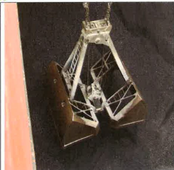
Ilustración 6. Método de descarga del barco a la tolva. https://ocw.unican.es/pluginfile.php/1479/course/section/1924/v2010_311_Tema11_TE.pdf
