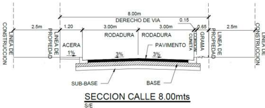
Imagen 6. Detalles de sección de calles 8.00m
