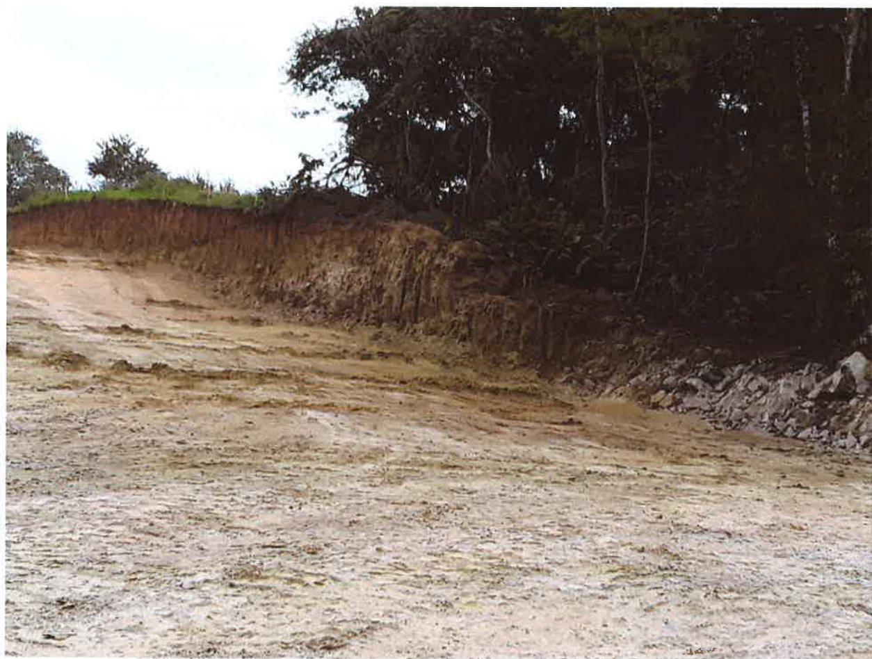
Zona de contacto de la arcilla con la arenisca Tobácea en profundidad
