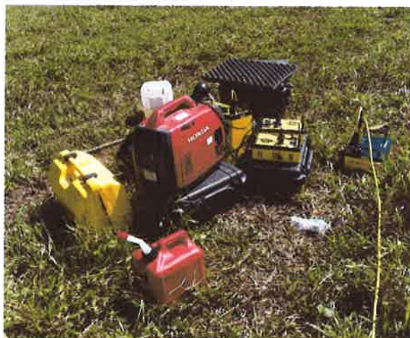
Figura 4. Adquisición de datos para realizar tomografías eléctricas en 2D.
