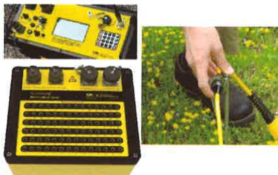
Figura 3. Resistivímetro, caja de conmutador y cables pasivos de la marca AGI.
