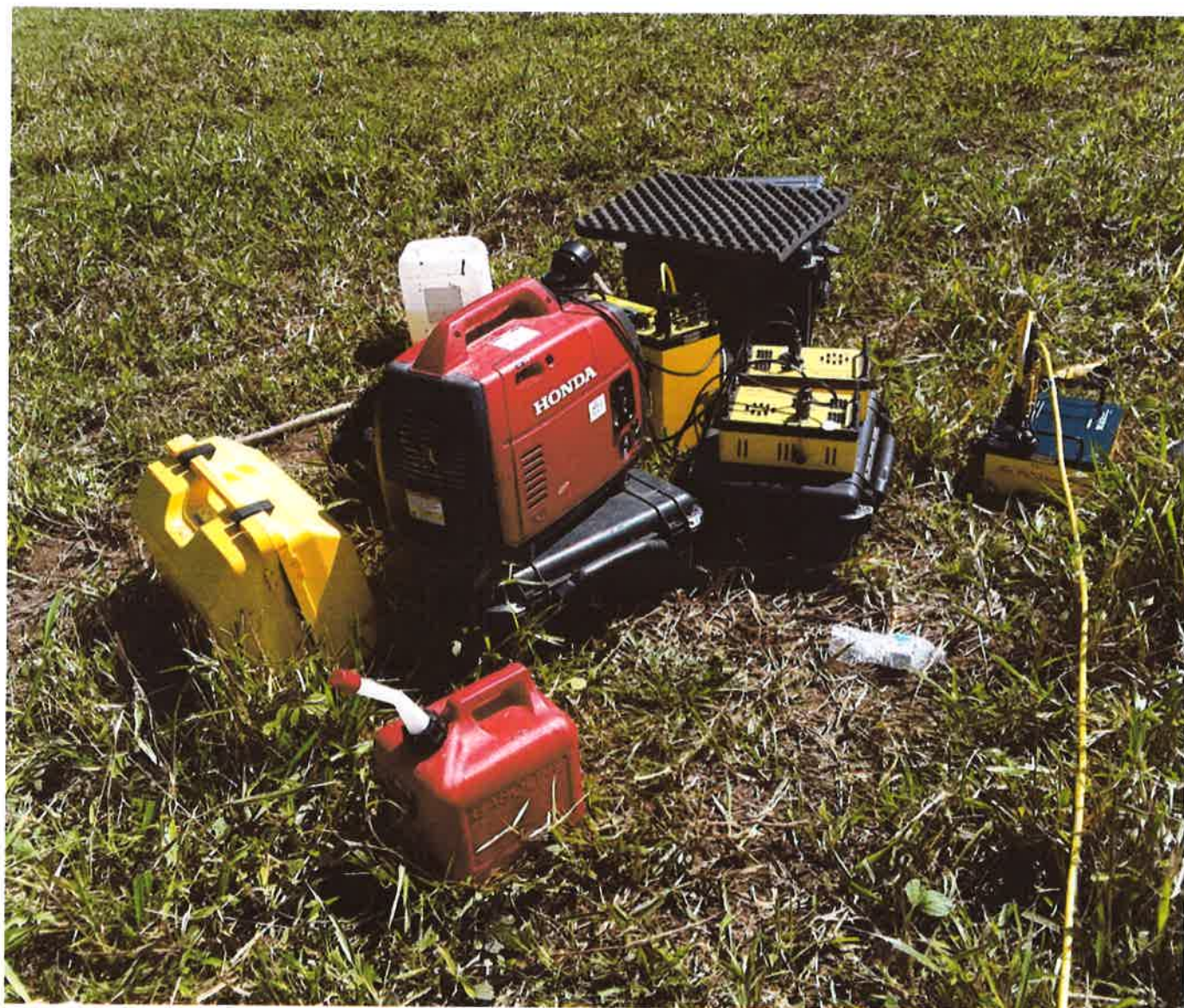
Equipo de tomografía eléctrica, Super Sting R8 y accesorio
