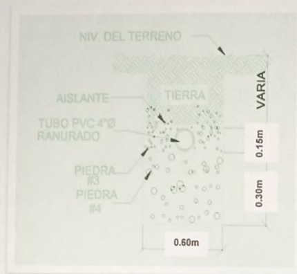
Fig. 3. Detalle de zanja para campo de filtración
