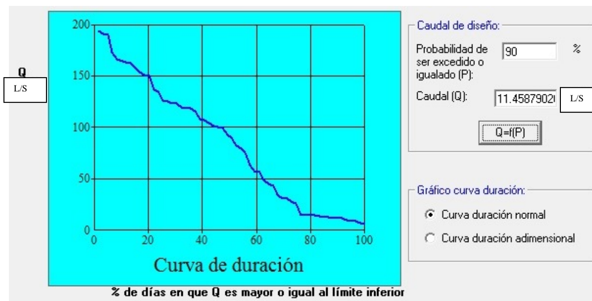
Figura #6. Curva de duración para año hidrológico (ene-dic) en el Proyecto (Quebrada Sin Nombre).
