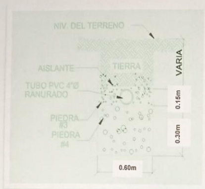
Fig. 3. Detalle de zanja para campo de filtración
