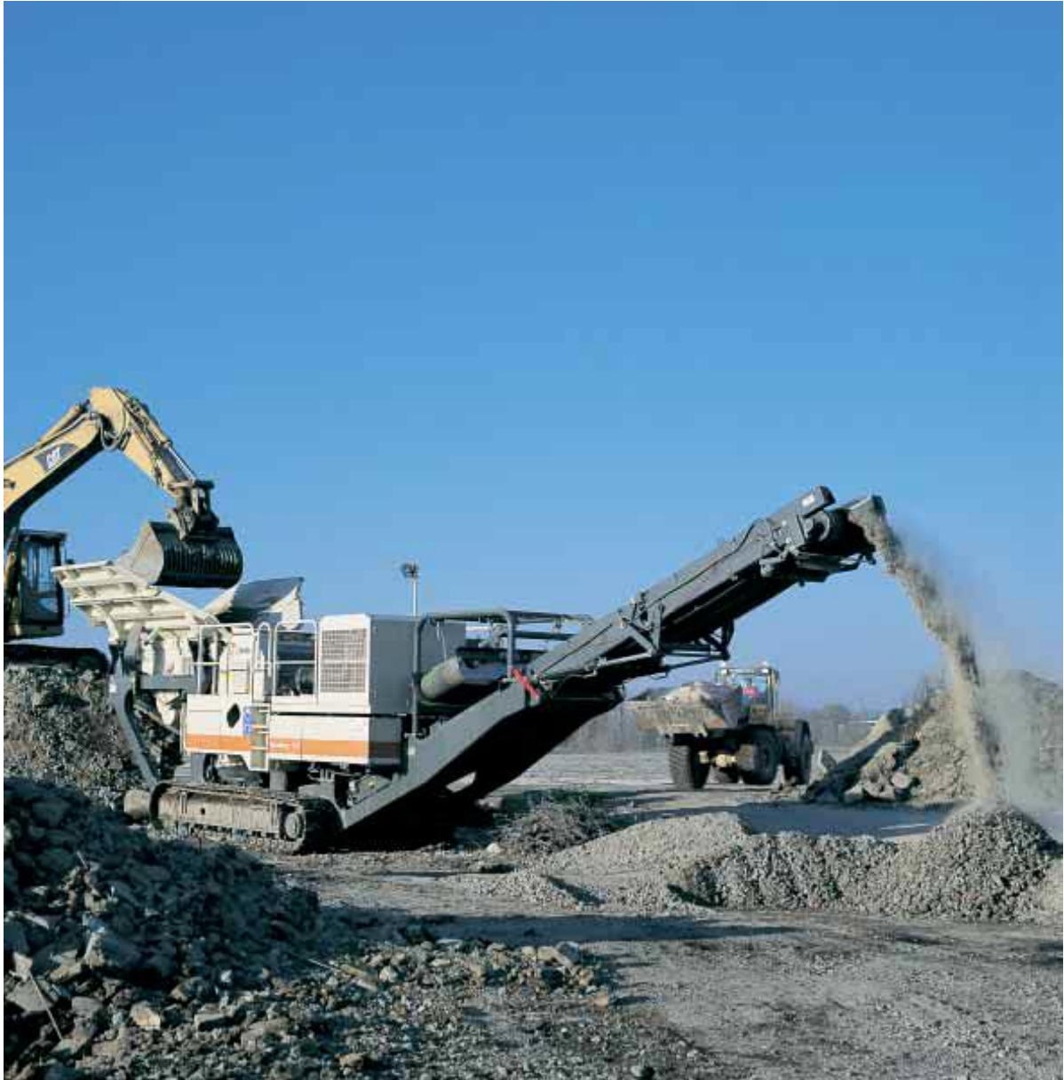
MODELO DE PLANTA DE TRITURACIÓN MONTADA SOBRE ORUGAS, BANDA DE TRANSPORTACIÓN Y ALIMENTACIÓN CON PALA MECÁNICA Y CARGADOR FRONTAL. Nordberg Serie LT, motor Cummins.
