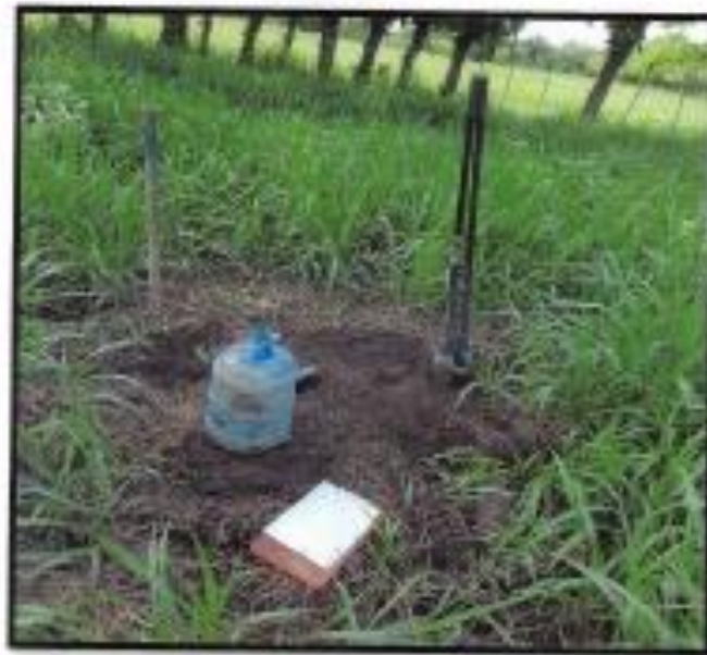
Foto 2: Excavación del hoyo 4 durante la prueba de percolación. 15 de Septiembre 2020.
