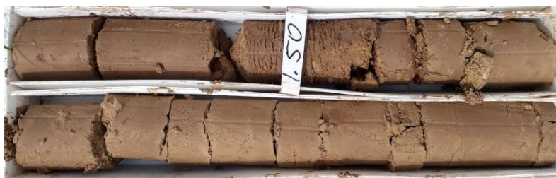
Figura 8. Testigo recuperado en el sondeo P-02 entre 3.7 m y 4.9 m de profundidad (SC).
