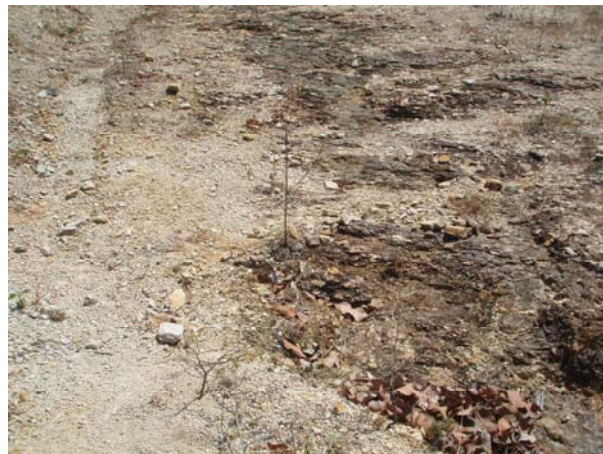
Foto No.6 y 7: La superficie de extracción de tosca se encuentra totalmente sin capa orgánica, la cual fue removida por las extracciones anteriores, dejando en la zona la tosca aflorante, sitio donde se continuará con la extracción de tosca y piedra.
