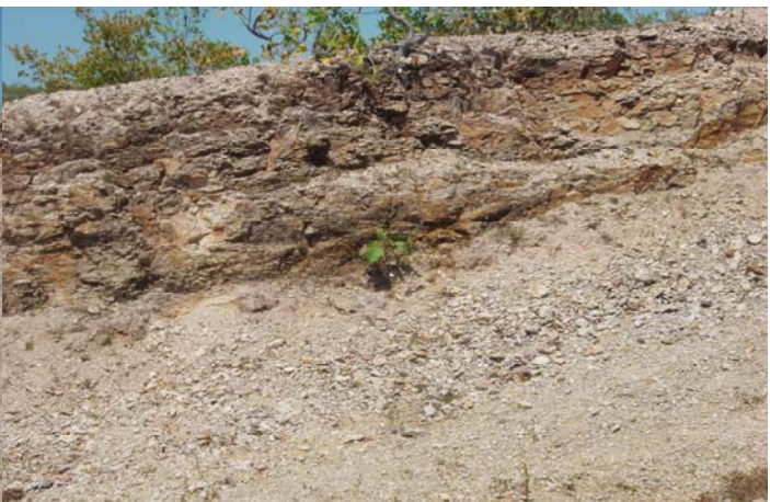
Foto No. 5: Frente de extracción existente de tosca, donde se iniciará la extracción de tosca para la rehabilitación de la carretera. En las capas inferiores del yacimiento se encuentra la piedra.
