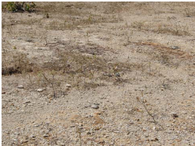
Foto No.6 y 7: La superficie de extracción de tosca se encuentra totalmente sin capa orgánica, la cual fue removida por las extracciones anteriores, dejando en la zona la tosca aflorante, sitio donde se continuará con la extracción de tosca y piedra.
