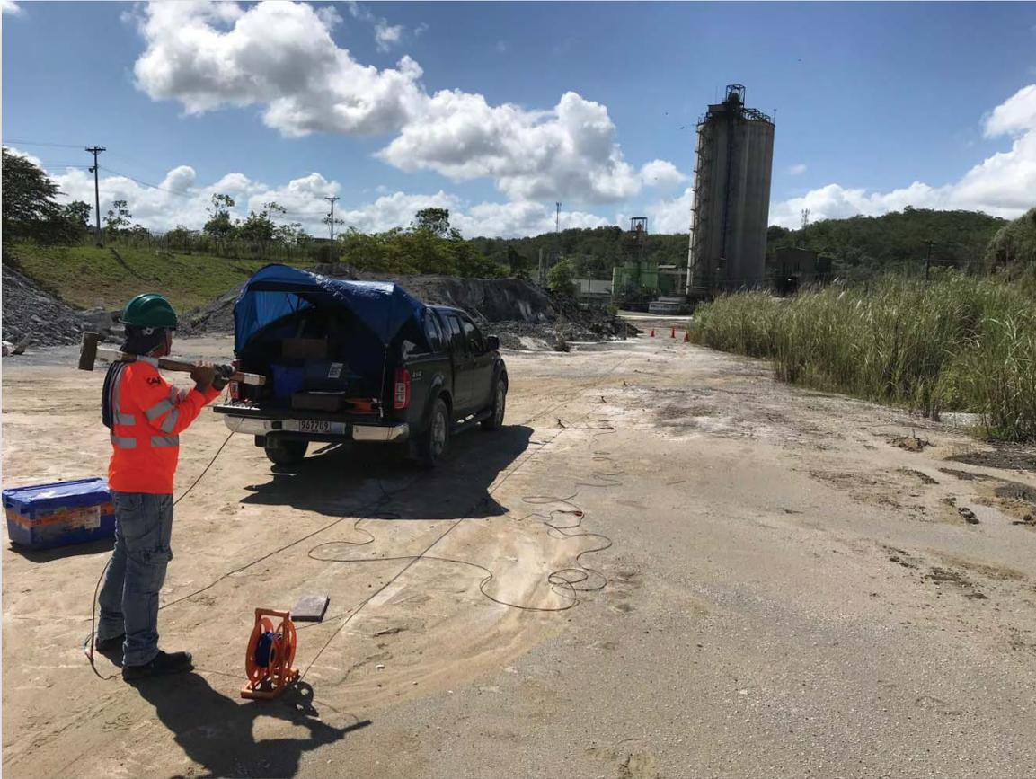
**Figura N° 1.2.1.- Perfil de sísmica de refracción.**
