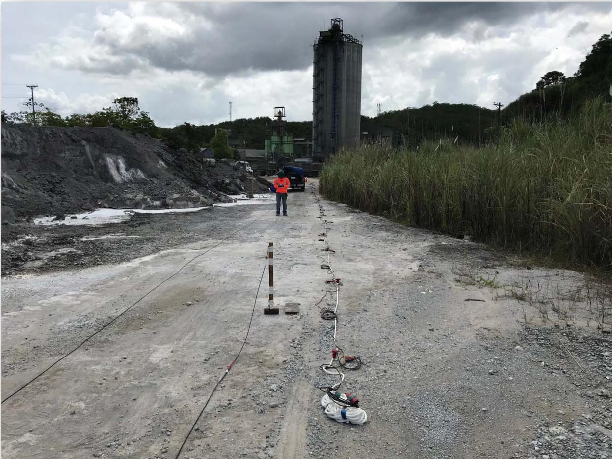
**Figura N° 2.2: Adquisición mediante técnica MASW (fuente activa).**
