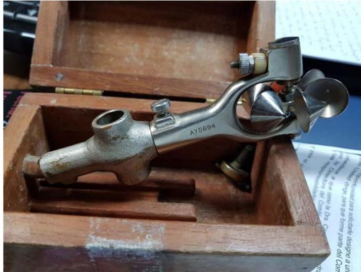
**Molinete tipo pigmeo utilizado en Quebrada Ancha para aforos de caudales pequeños**
