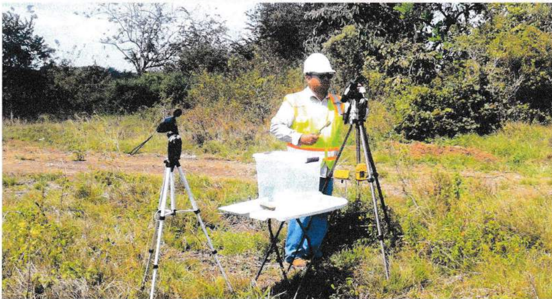
Monitoreo de Calidad de Aire y Ruido Ambiental. Punto dentro del polígono del proyecto.
