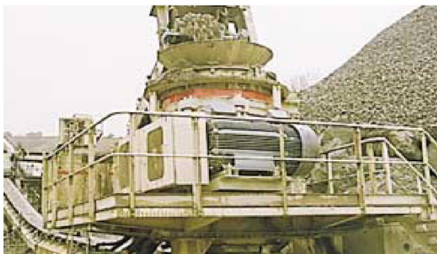
Aplicación secundaria : Molino de cono HP 300 secundario preparando los materiales para un HP 400 terciario.
