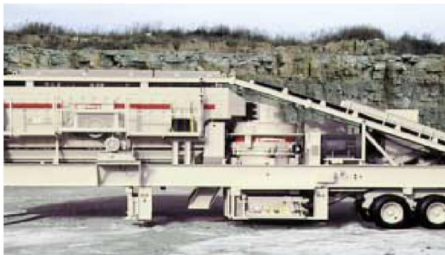
Aplicación móvil : Molino de cono HP300 en versión grupo móvil
