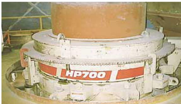
Aplicación en minas : Molino de cono HP700 tratando mineral de cobre
