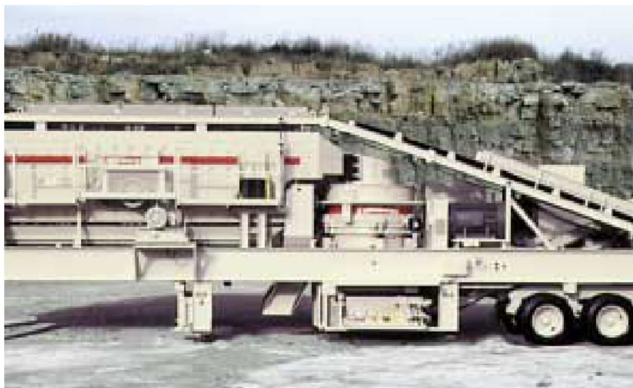
Aplicación móvil : Molino de cono HP300 en versión grupo móvil
