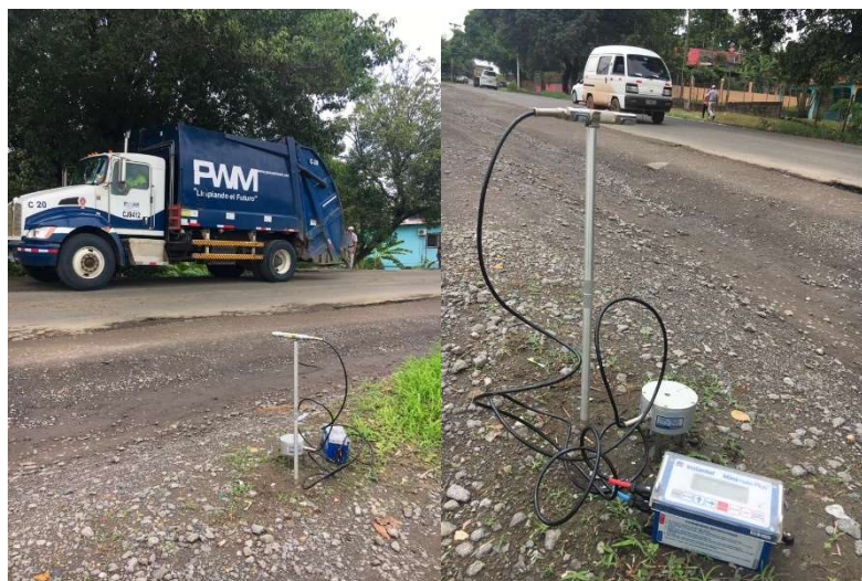
Figura 6 – 28. Prueba de Vibración Frente a Gran Plaza Tocumen.
