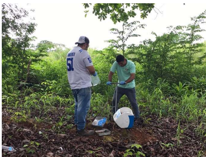
Figura 6 - 3. Colecta de suelo para análisis – Muestra 1.
