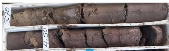
Figura 8. Testigo recuperado en el sondeo P-02 entre 3.7 m y 4.9 m de profundidad (SC).
