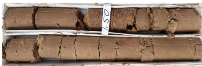
Figura 8. Testigo recuperado en el sondeo P-02 entre 3.7 m y 4.9 m de profundidad (SC).
