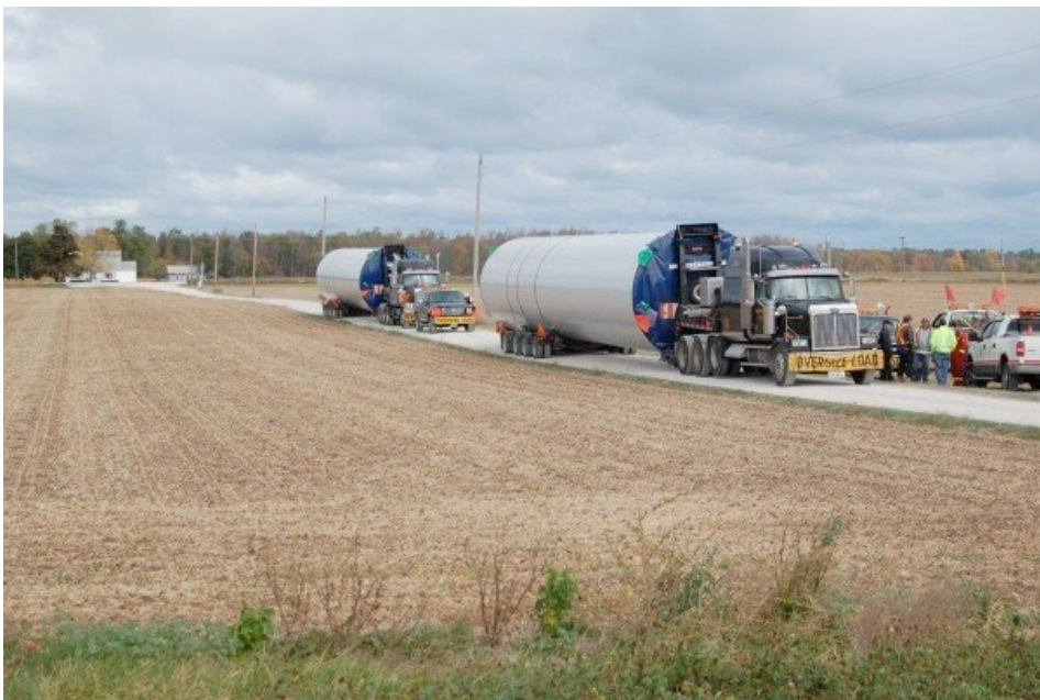
Figura 5-12: Transporte de torres de aerogeneradores
