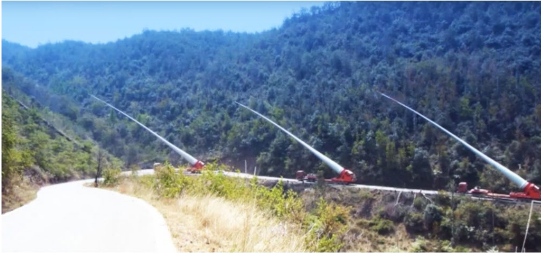
Figura 5-13: Transporte de aspas de aerogeneradores
