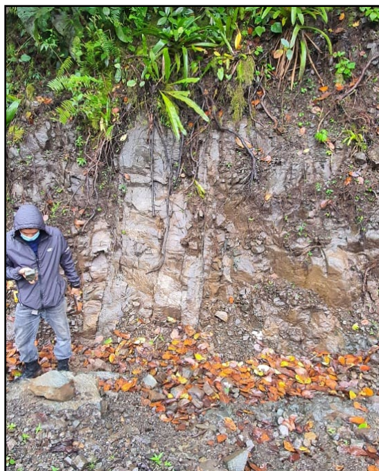
Fotografía 15. Andesita altamente fracturada por diaclasas verticales, ubicada en sitio S-9b.
