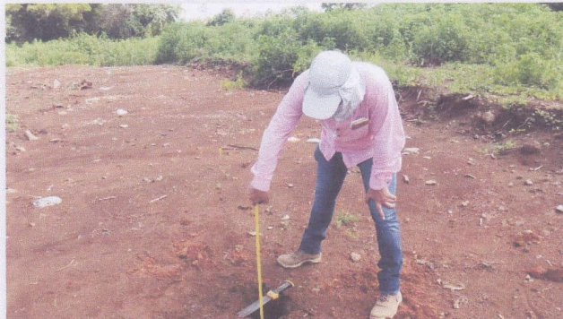
Foto 2: Medición del descenso del agua en el hoyo. 25 Junio 2020.
