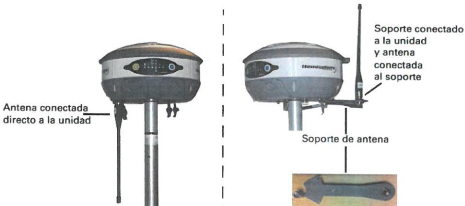
Ilustración 21. GPS Hemisphere S320 Doble Frecuencia
