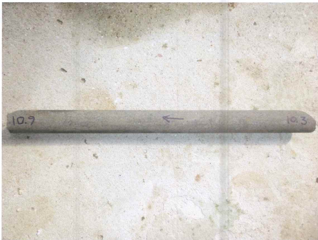
FOTO No 14: MUESTRA DE ROCA UTILIZADA PARA EL ENSAYO DE RESISTENCIA ÚLTIMA A LA COMPRESIÓN NO CONFINADA.
