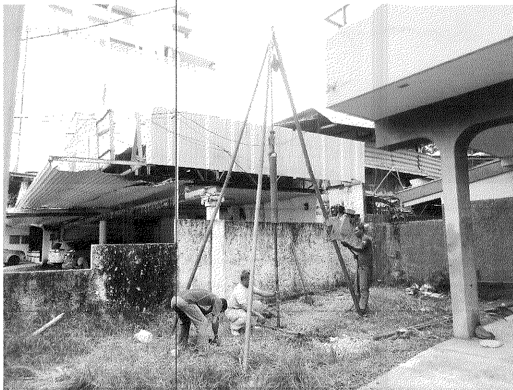
FOTO No 2: PERFORACIÓN A PERCUSIÓN No. 1; IZQUIERDA Y ADELANTE DEL TERRENO.
