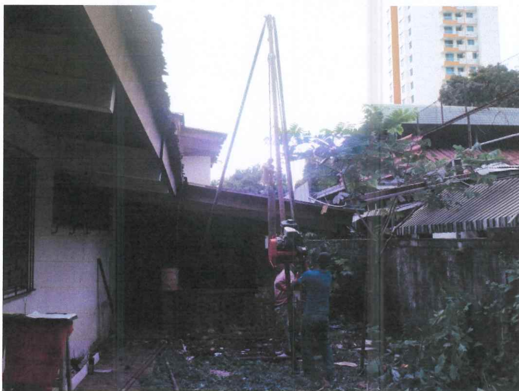
FOTO No 7: PERFORACIÓN A PERCUSIÓN No. 4; IZQUIERDA Y CENTRO DEL TERRENO.
