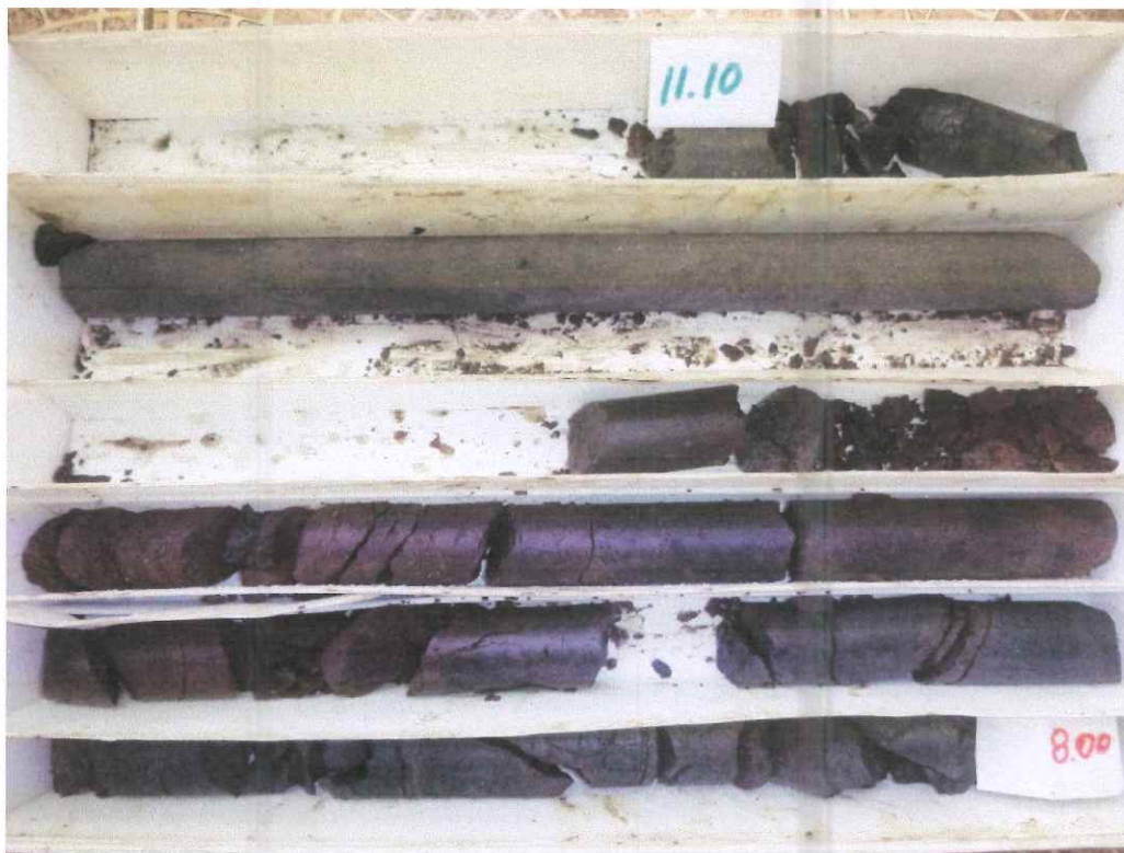
FOTO No 10: MUESTRAS DE ROCA EXTRAÍDAS DEL HOYO No.1, A LA PROFUNDIDAD DE 8.00 A 11.10 M.
