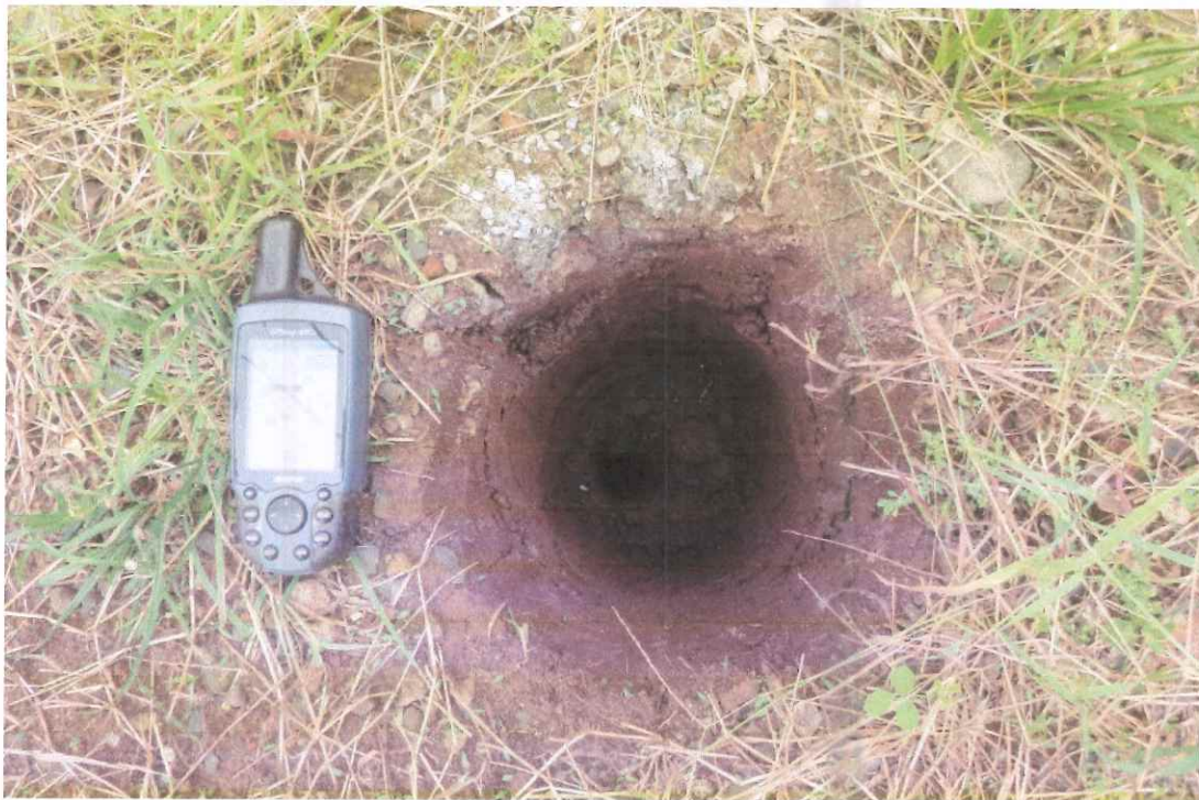
FOTO No 13: POSICIONAMIENTO DE LAS PERFORACIONES CON EQUIPO GPS.
