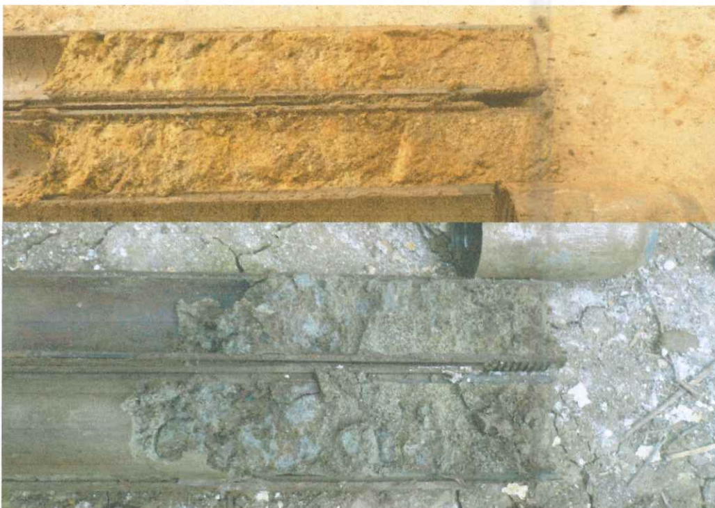
FOTO No 9: MUESTRAS DE ARENA ARCILLOSA EXTRAÍDAS DE LOS HOYOS, A LA PROFUNDIDAD DE 4.00 A 4.55 M.
