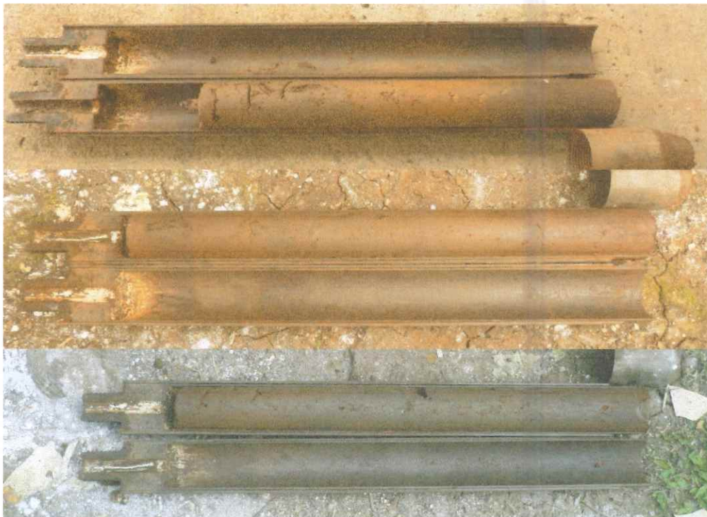
FOTO No 8: MUESTRAS DE ARCILLA DE ALTA COMPRESIBILIDAD EXTRAÍDAS DE LOS HOYOS, A LA PROFUNDIDAD DE 0.50 A 2.00 M.
