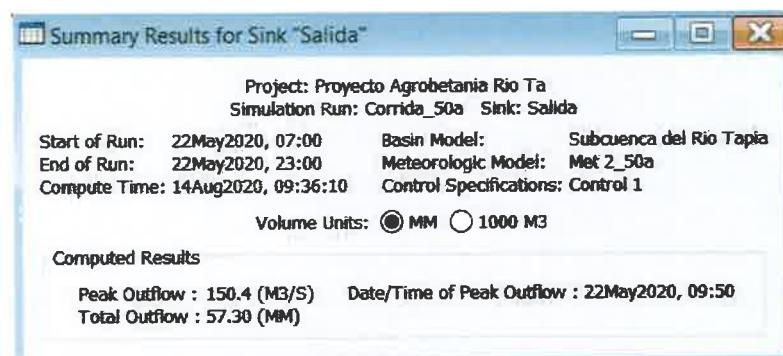
Figura 18. Salida del Hidrograma de Diseño para un periodo de 50 años del río Tapia
