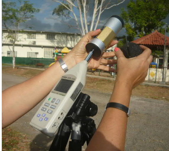
Foto 1. Calibración del Sonómetro
