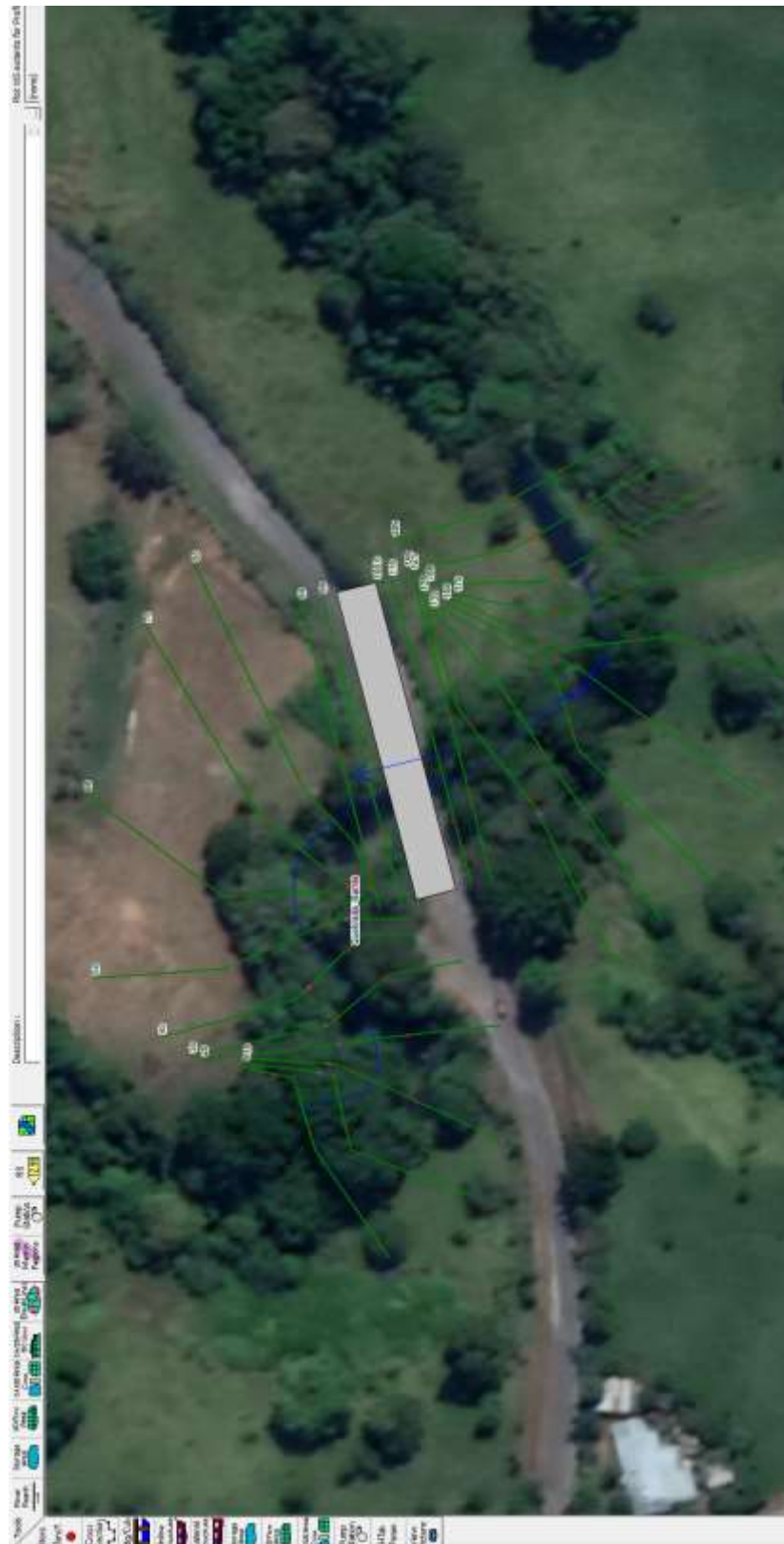
Figura 3. Planta con Modelo de HEC-RAS
