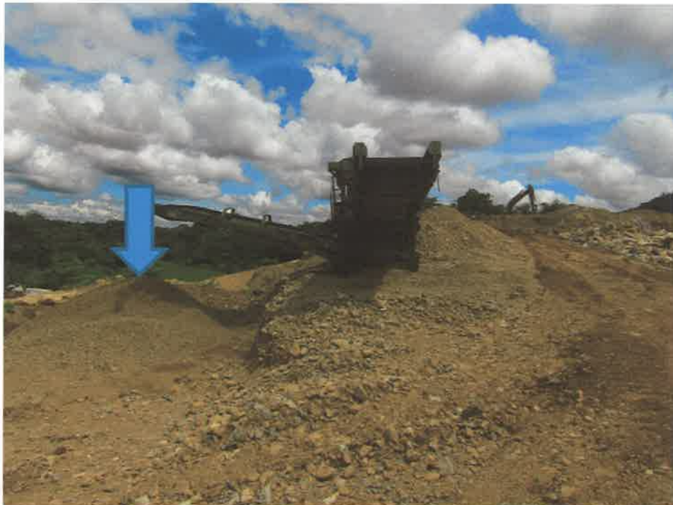
Figura 5. Criba utilizada para separar tosca de piedra caliza.
