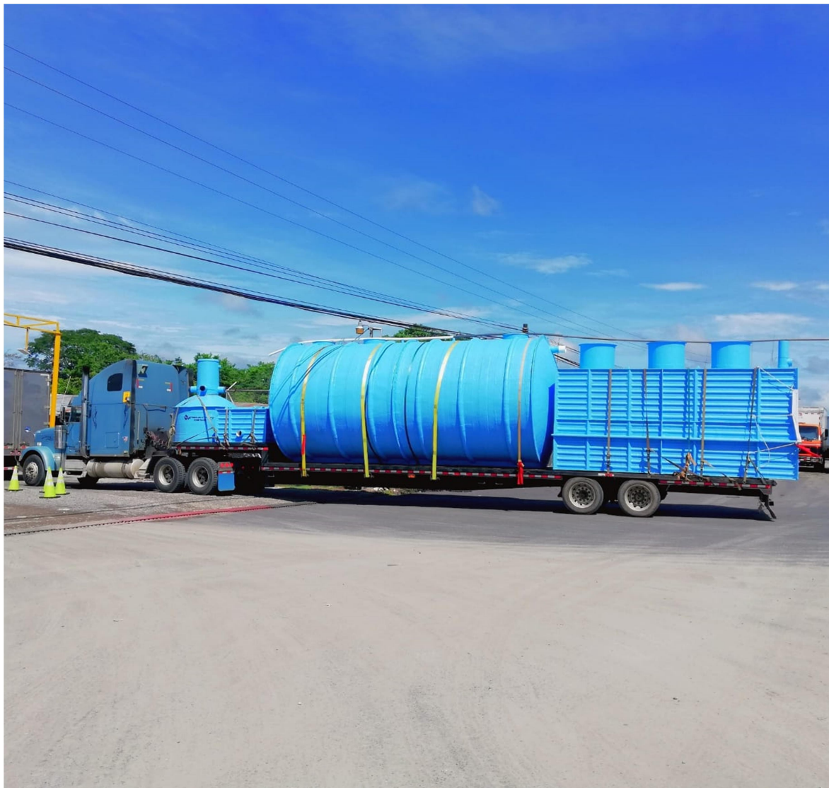
ANEXO 1. Imagen Sistema de Tratamiento para Aguas Residuales, Tanque Séptico Mejorado, modelo TSM-60 000, siendo transportado por la frontera Costa Rica-Panamá.
