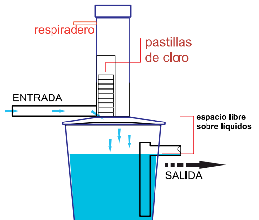
Sistema de Cloración integrado con Tanque de Retención
