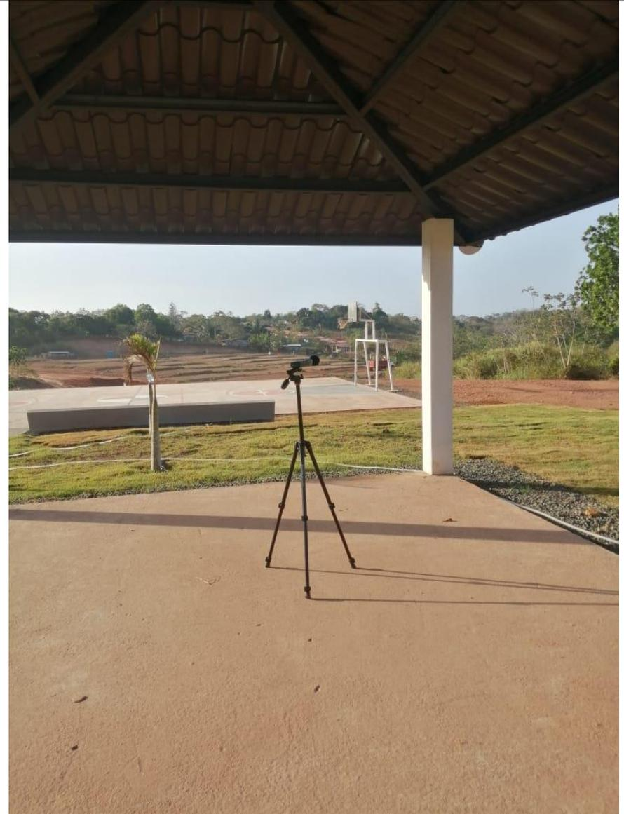
14. Vista de Sonómetro realizando mediciones de ruido ambiente en la huella del proyecto.
