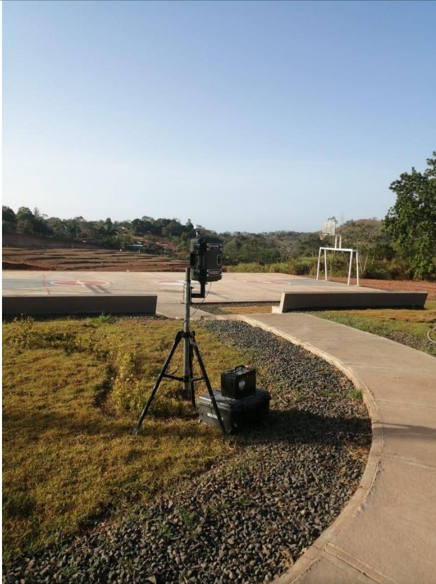
13. Vista de Monitor de Calidad de Aire realizando mediciones de concentraciones de (PM10, SO<sub>x</sub>, NO<sub>x</sub>) en la huella del proyecto.
