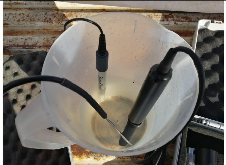
12. Vista de mediciones de Ph, Oxígeno Disuelto y Temperatura
