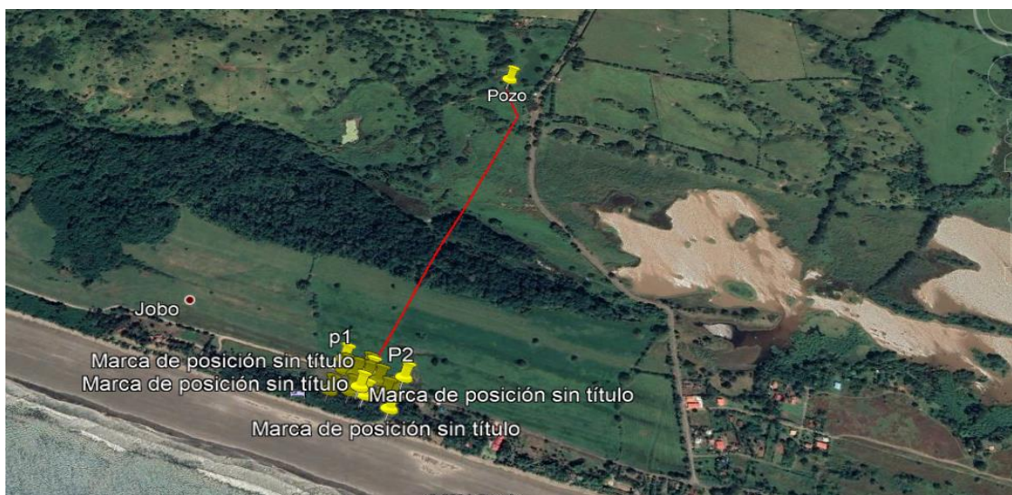
Imagen 6. Esquema de la línea de conducción de agua propuesto, en su mayoría debe atravesar potrero y parte del manglar.
