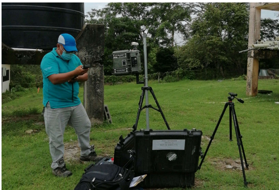
Imagen 6-4. Ejecución de monitoreos de calidad de aire y ruido ambiental.
