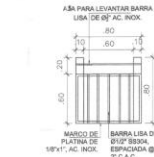
DETALLE DE REJILLA TIPO 1 Sin Escala
