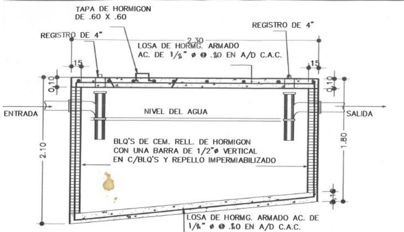
SECCION DE TANQUE SEPTICO
