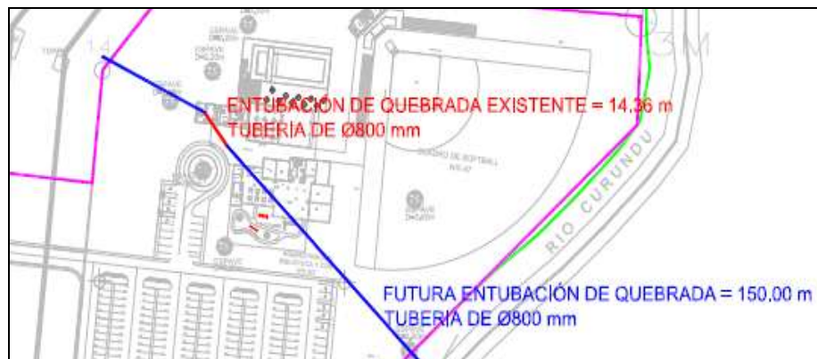
Figura N° 1. Esquema que dice de como se planifica el entubamiento de un tramo de quebrada s/n, que atraviesa el polígono y descarga en el río Curundú
