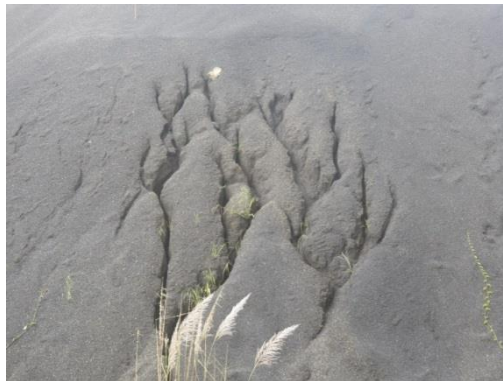
Foto 6. Arrastre y erosión del material triturado dispuesto en pilas.
