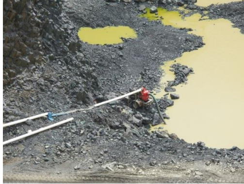
Foto 2. Sistema de bombeo empleado para evacuar las aguas del fondo del PIT.
