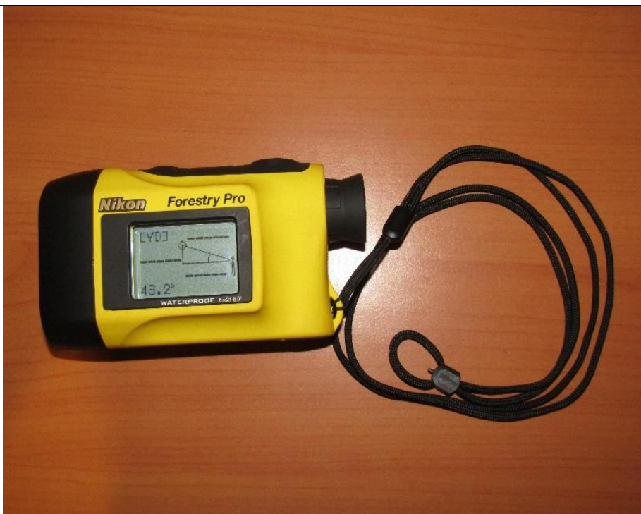
Hipsómetro a laser Nikon Forestry Pro II utilizado para el cálculo de alturas de los árboles
