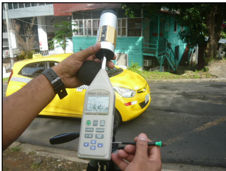
Observamos el momento en que se realizaba la calibración del Sonómetro durante el Monitoreo de Ruido Ambiental, en el punto PRC-1.
