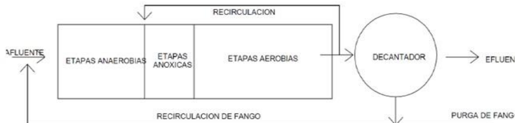
ESQUEMA GENERAL PROCESO A2/O
