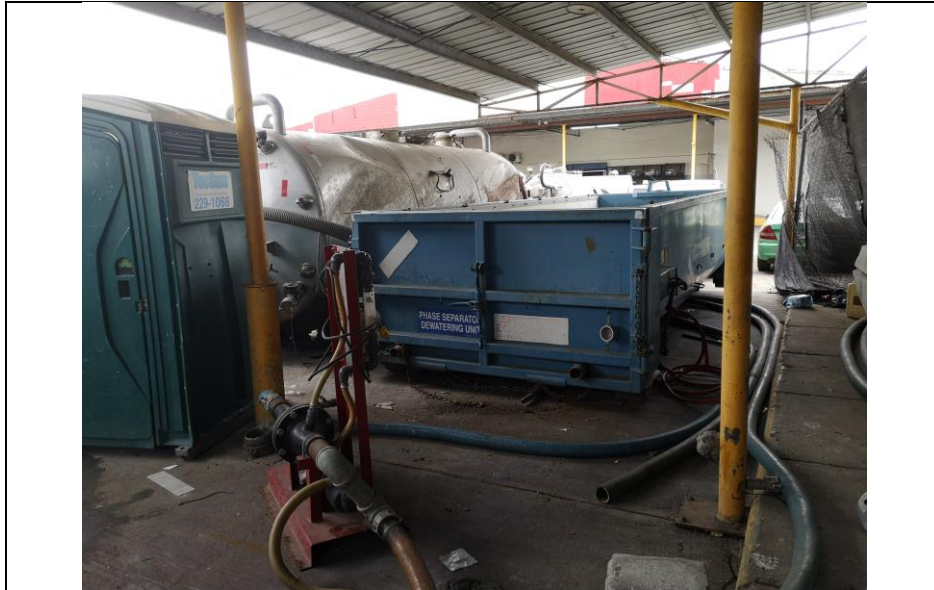
Foto No. 1 Tanque de reserva y caja deshidratadora a instalar.
