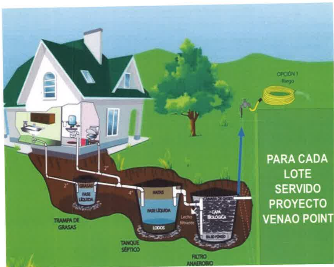
Figura N°1: Esquema propuesto para la instalación y operación del Sistema Bio-Digestor.
