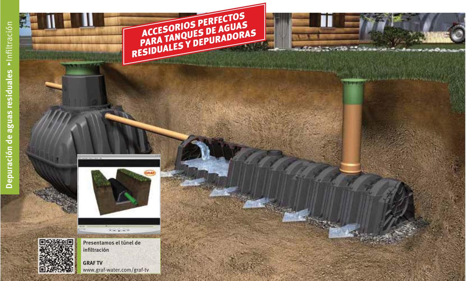
¿No hay ningún río o zona para evacuar el agua depurada cerca de su casa? Entonces puede infiltrar el agua depurada en el subsuelo utilizando el Túnel de Drenaje GRAF. Sólo necesita un terreno suficientemente permeable a una distancia mínima de 80 cm de los niveles freáticos.
