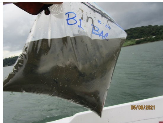
Foto 6) Foto 6) Muestra de bentos colectada en B1, punto más alejado de la costa, sustrato fangoso limoso.
