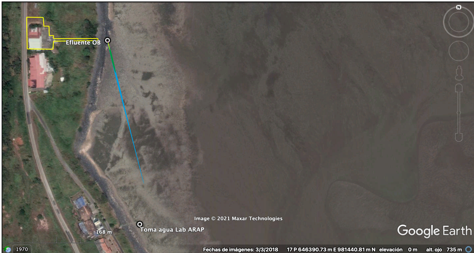
Figura 13. Representación gráfica de la pluma de dispersión de A&G en la ensenada de Bique en marea vaciante
