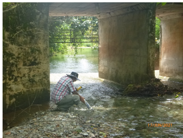
Figura 6-15. Registros de parámetros de calidad de agua en tiempo real – Sonda Multiparamétrica Hydrolab DS5.
