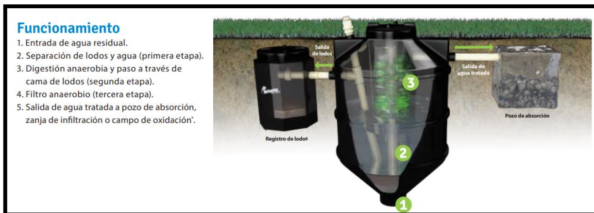
Imagen No.2: Funcionamiento del sistema sanitario (Biodigestor)
