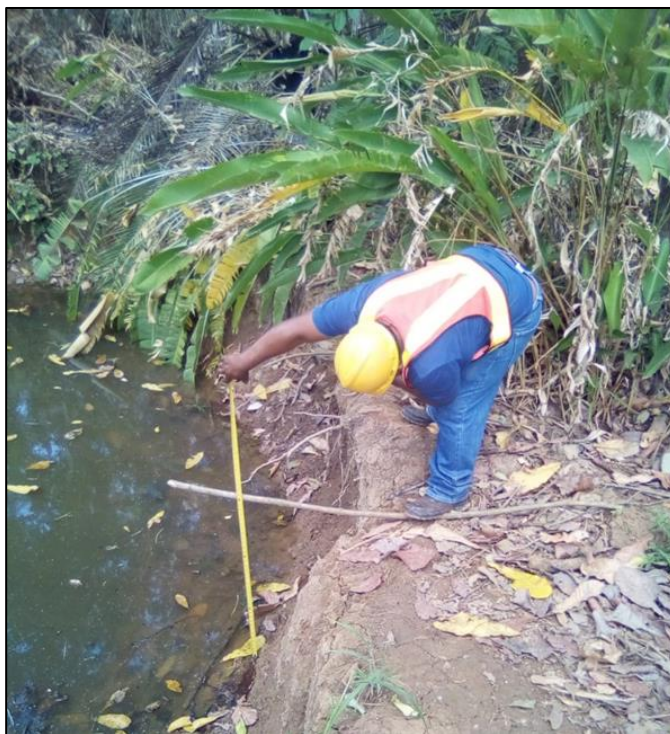
Figura 11. Medición de nivel de agua en fosa para verificar su influencia en el entorno.
