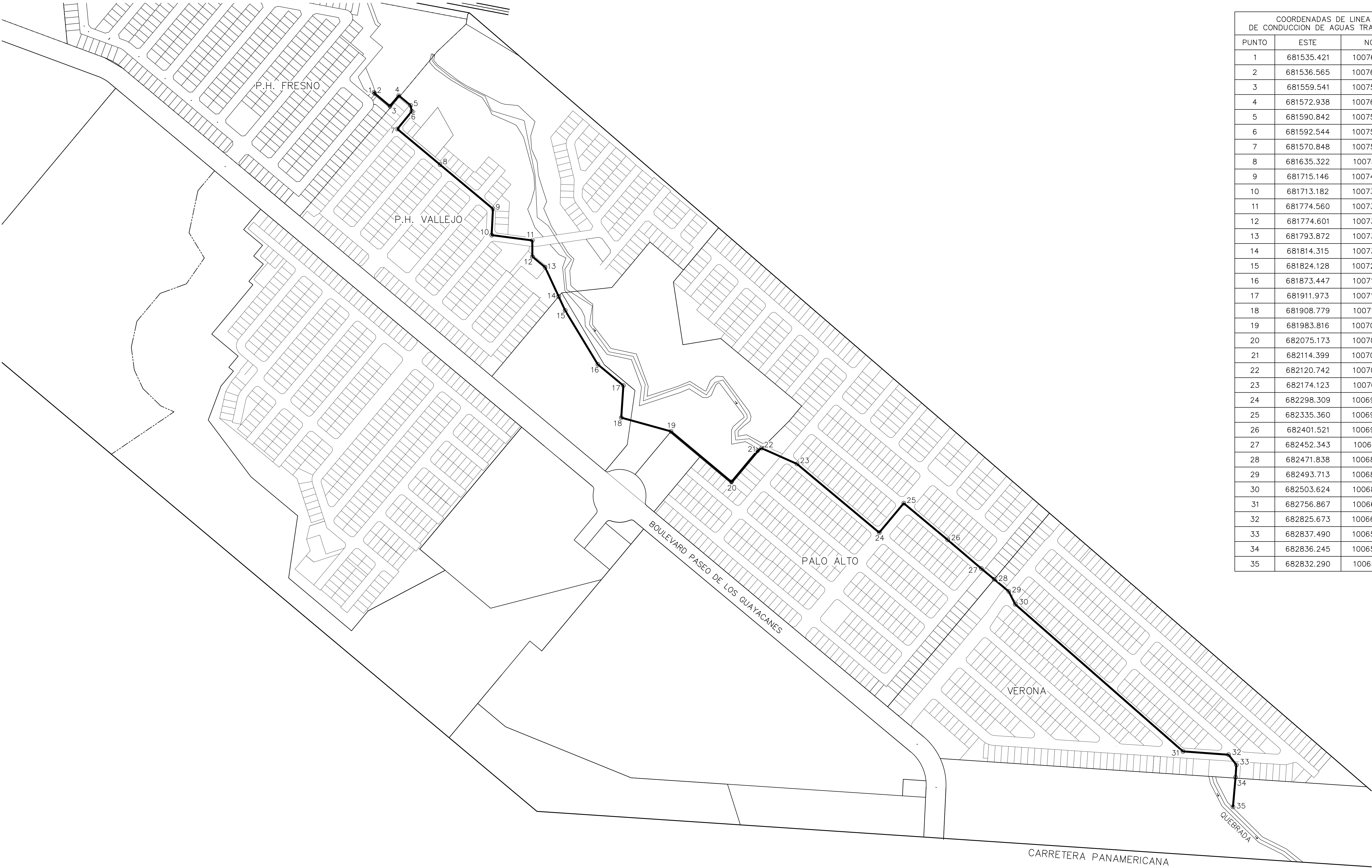
ESQUEMA DE DESCARGA DE LAS AGUAS TRATADAS DE LA PLANTA DE TRATAMIENTO ESC. 1: 2500 DATUM WGS-84
