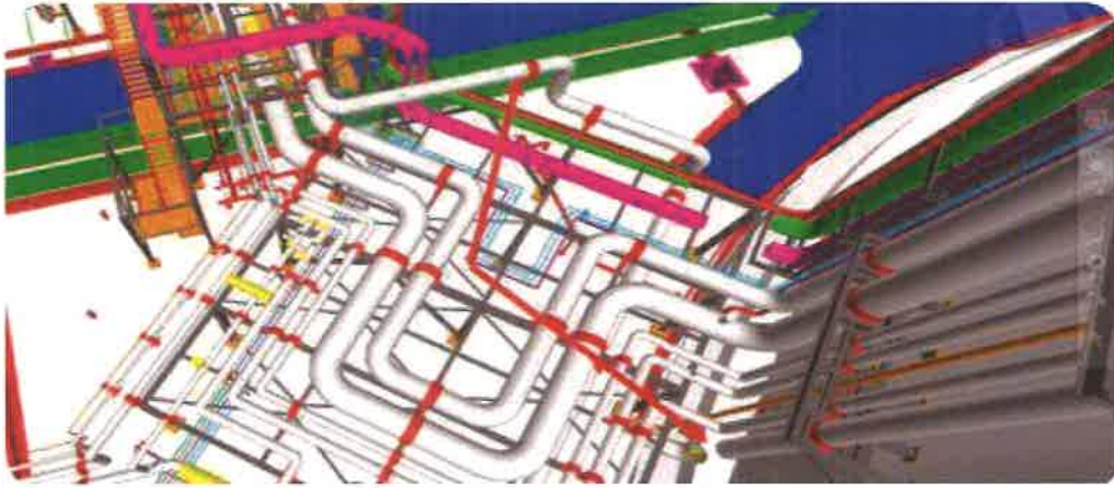
Figura 5. Vista de tubería a instalar a un costado del tanque de almacenamiento para el suministro de GNL a barcos
