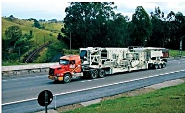
NW80 200HPS siendo transportado, traccionado por caballo mecánico.
