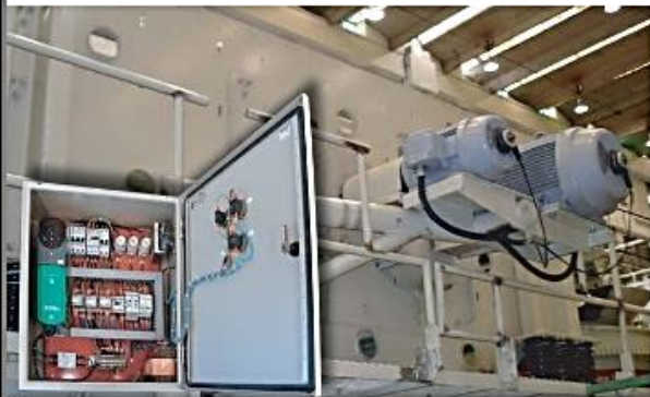
Zaranda de movimiento elíptico con sistema SMARTspeed.
