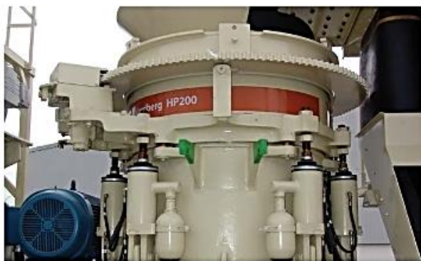
Trituradora secundaria de cono Nordberg (HP100 o HP200).
