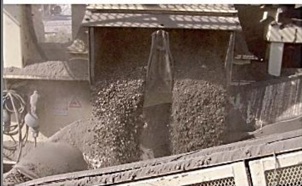
Canaleta vibratoria con salidas para 2 materiales diferentes.
