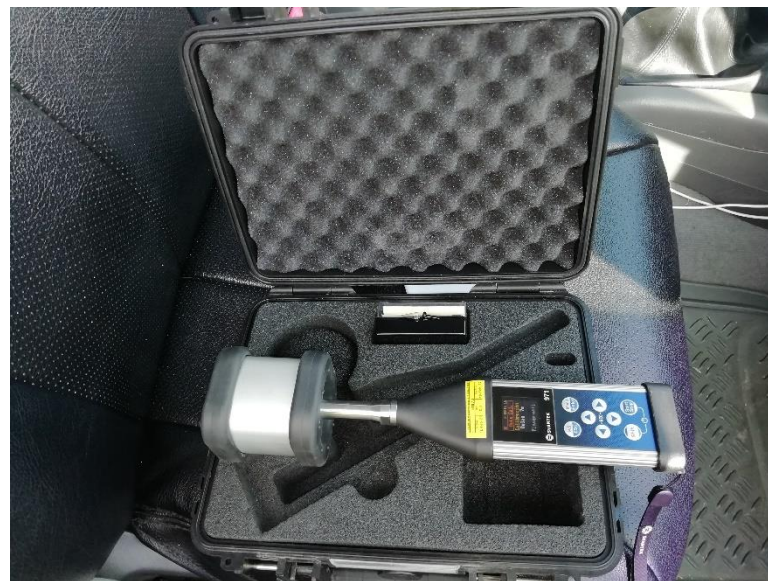
Fotografía 2: Calibración del sonómetro SVAN 971 con el pistófono calibrador.
